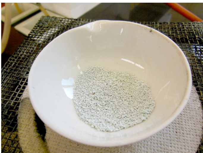
Obrázek 8: Úplné odpaření krystalové vody
