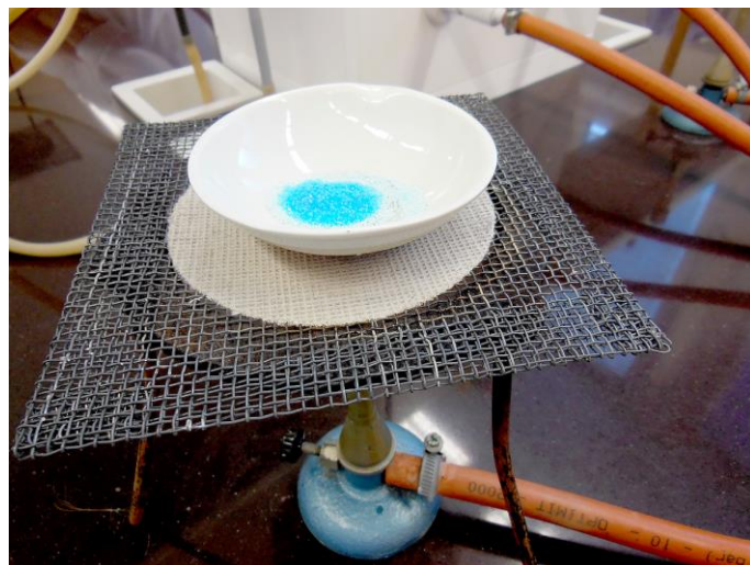
Obrázek 7: Částečné odpaření krystalové vody
