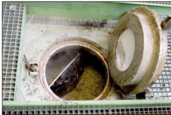
Obrázek 18: Nerezový difuzér
