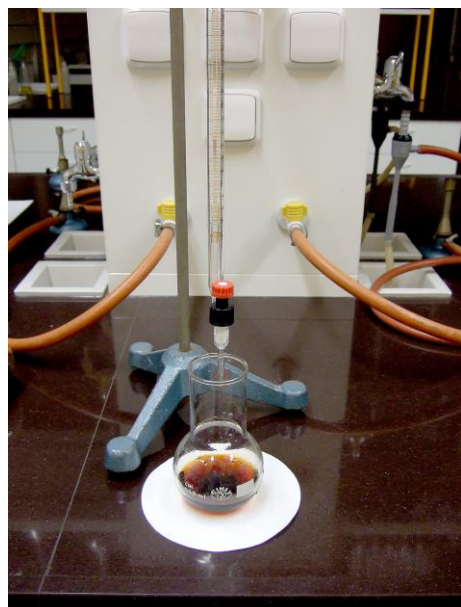
Obrázek 3: Titrační aparatura
