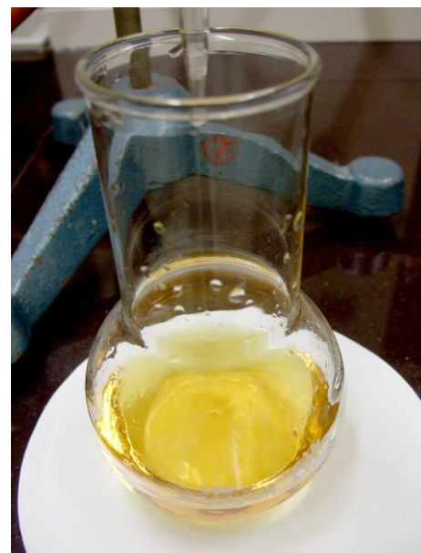
Obrázek 5: Světle žluté zbarvení roztoku vzorku před přidáním škrobového mazu
