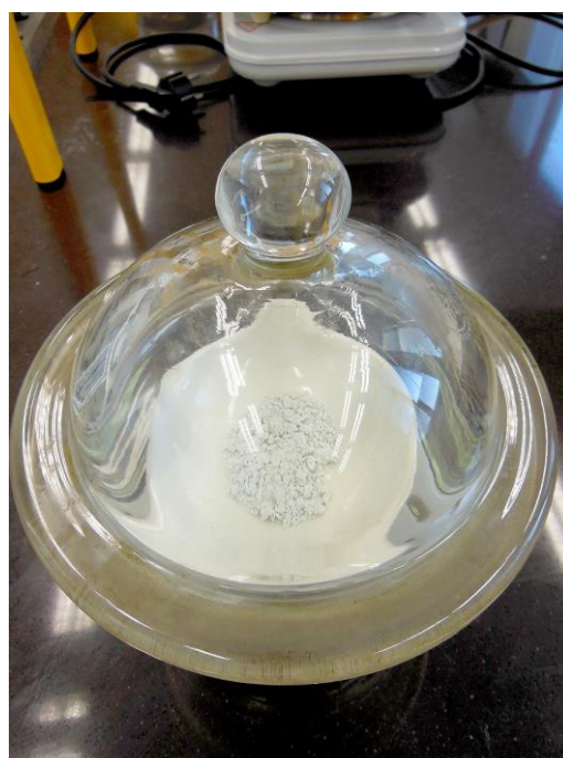
Obrázek 9: Umístění bezvodého vzorku do exsikátoru
