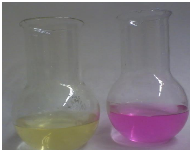
Obrázek 2: Barevná změna indikátoru (fenolová červen)
