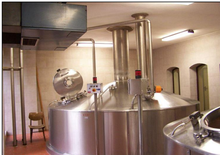
Obrázek 16: Vystírací kád' z nerez oceli
