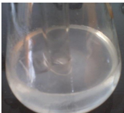
Obrázek 2: Vápenná voda v kuželové baňce se vlivem reakce s oxidem uhličitým postupně zakalí
