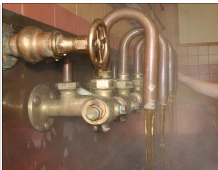
Obrázek 23: Vypouštění sladiny ze scezovací kádě
