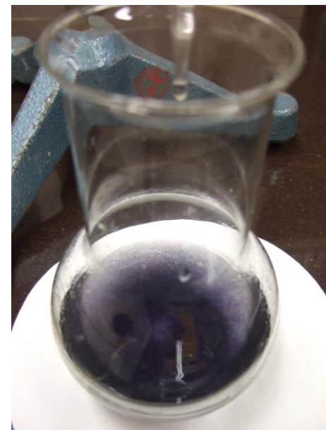
Obrázek 8: Postupné zesvětlování barvy vzorky při titraci
