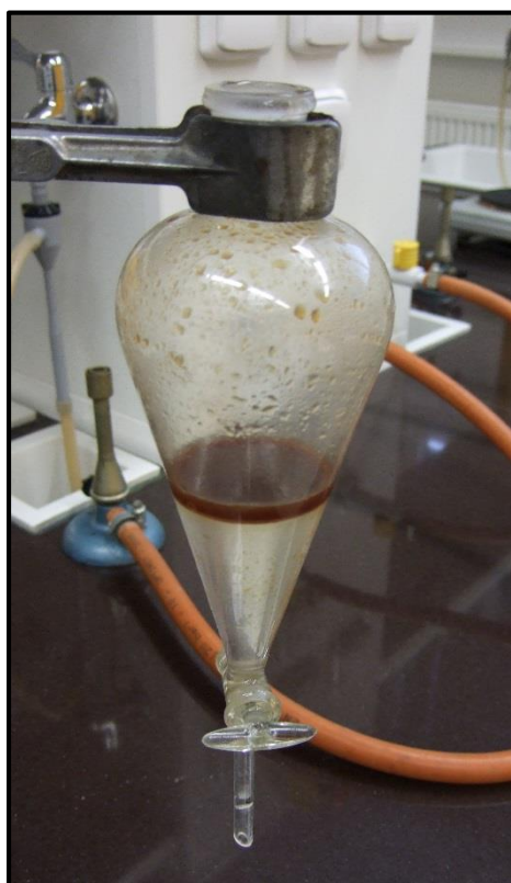
Obr. 10: Extrakce kofeinu do chloroformu
