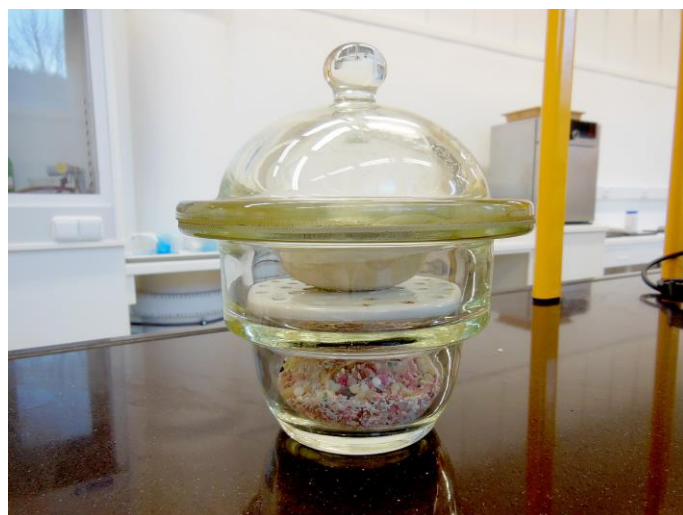
Obrázek 5: Umístění vyžíhané misky do exsikátoru
