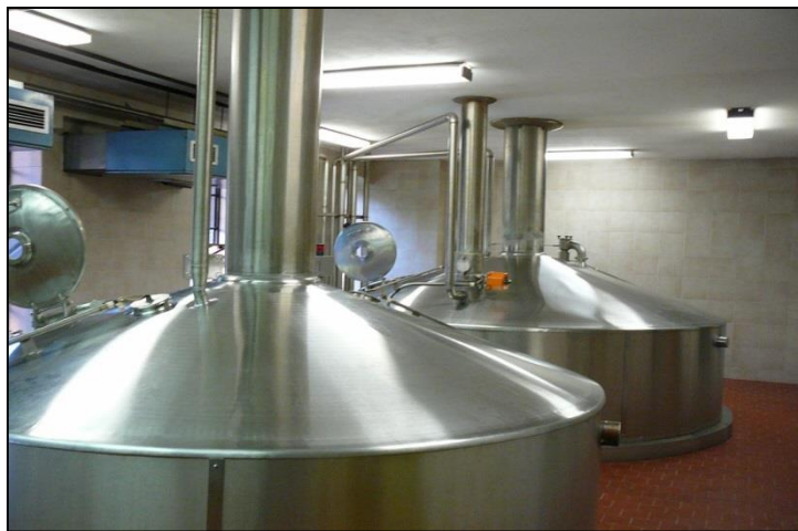
Obrázek 18: Vystírací kád' a rmutovací kotel
