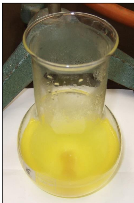
Obrázek 3: Barevné změny titrovaného slané roztoku
