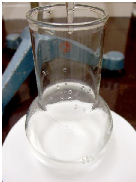
Obrázek 10: Odbarvený roztok vzorku po titraci
