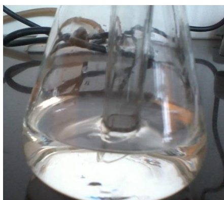
Obrázek 2: Vápenná voda v kuželové baňce se vlivem reakce s oxidem uhličitým postupně zakalí
