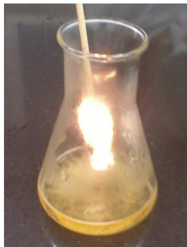
Obrázek 6: Stejně se rozhoří doutnající špejle při rozkladu peroxidu vodíku s katalyzátorem jodidem draselným
