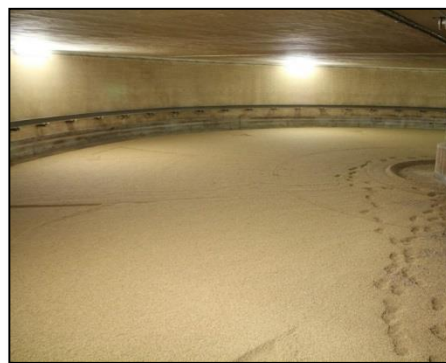
Obrázek 14: Slad na lísce uvnitř
