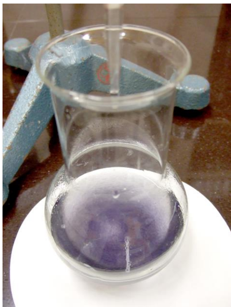
Obrázek 9: Zbarvení vzorku těsně před bodem ekvivalence
