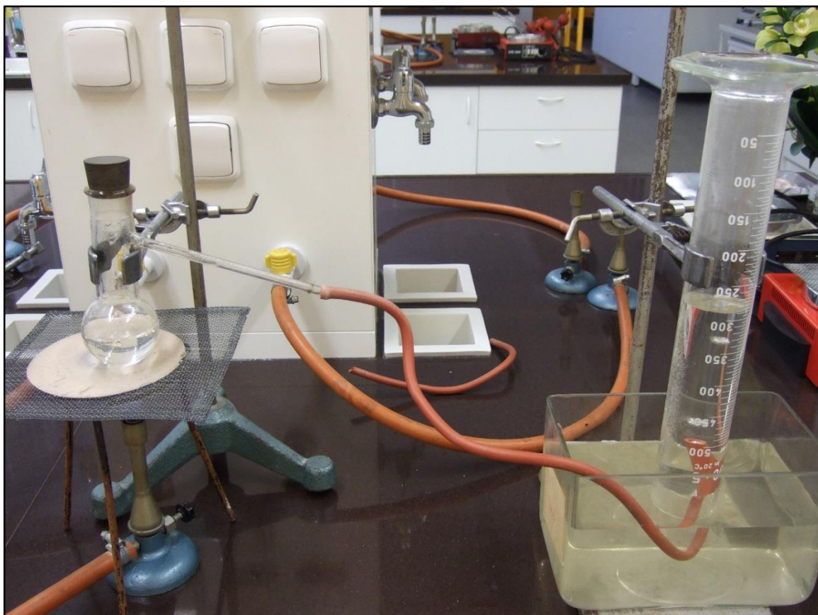
Obrázek 5: Celá aparatura na jímání CO 2
