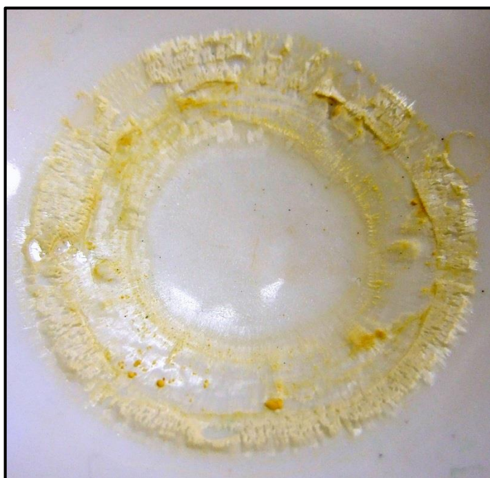
Obr. 11: Krystalky kofeinu po odpaření chloroformu
