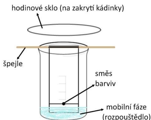
Obrázek 4: Vzestupné uspořádání při chromatografii
