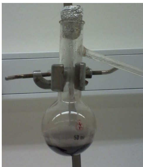
Obrázek 8: Rozklad peroxidu vodíku urychlený oxidem manganičitým
