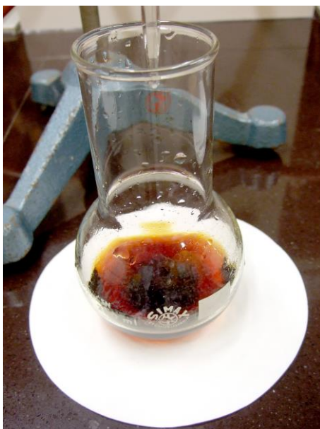
Obrázek 4: Zbarvení roztoku jodové tinktury před titrací
