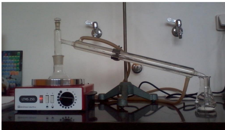
Obrázek 1: Aparatura pro dekarboxylaci kyseliny salicylové
