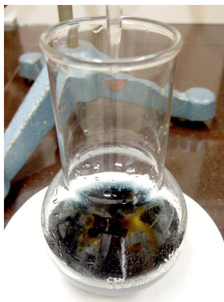
Obrázek 1: Zbarvení vzorku po přidání škrobového mazu
