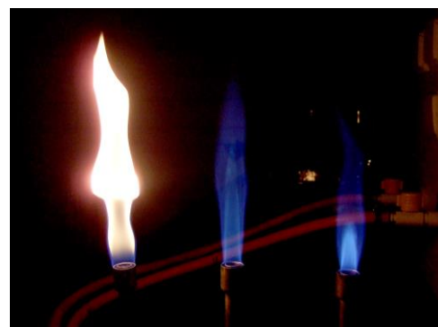
Obrázek 12: Typy plamene Bunsenova kahanu. Zleva: 300\text{--}500^\circ\text{C} , 1000^\circ\text{C} , 1550^\circ\text{C} .
