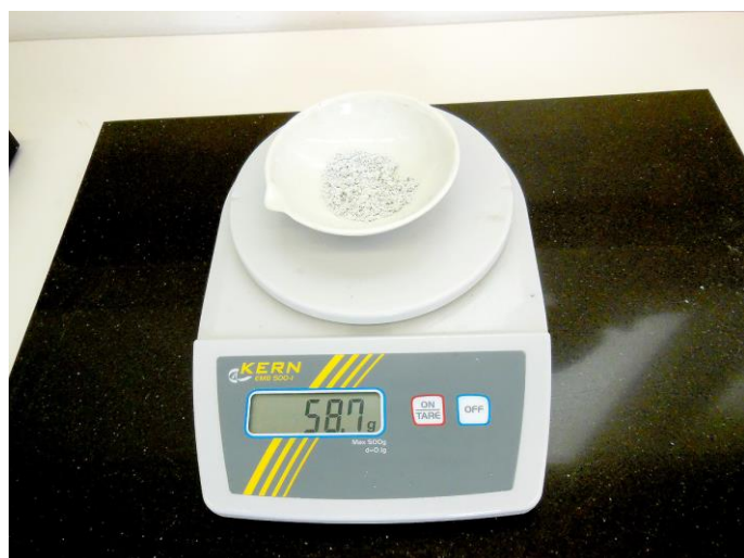
Obrázek 10: Vážení bezvodého vzorku
