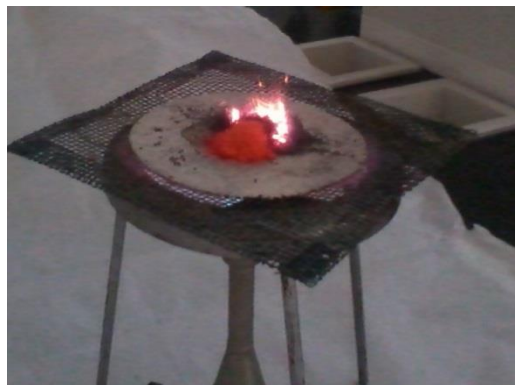
Obrázek 8: Příprava oxidu chromitého – pokus s názvem "sopka"
