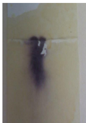
Obrázek 5: Zbarvení skvrny kyseliny acetylsalicylové po detekci chloridem železitým
