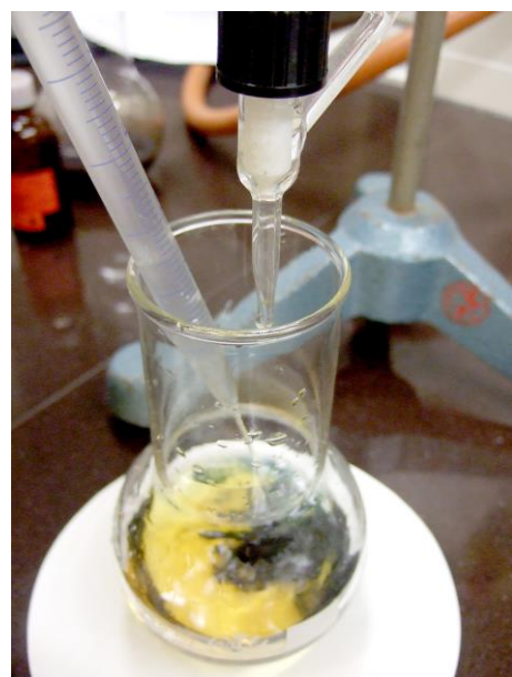
Obrázek 6: Přidávání škrobového mazu
