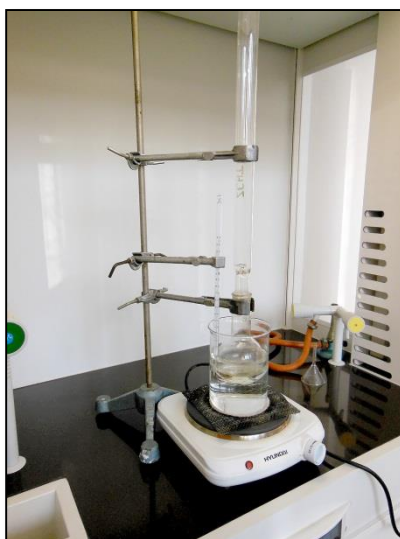
Obrázek 7: Aparatura se zpětným vzdušným chladičem
