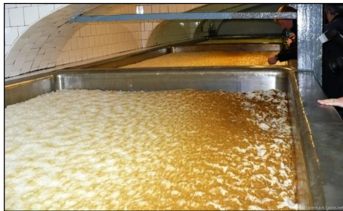
Obrázek 27: Kvasná kád' na spilce II
