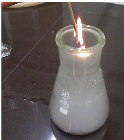
Obrázek 5: Doutnající špejle se nad peroxidem vodíku s oxidem manganičitým rozhoří jasným plamenem
