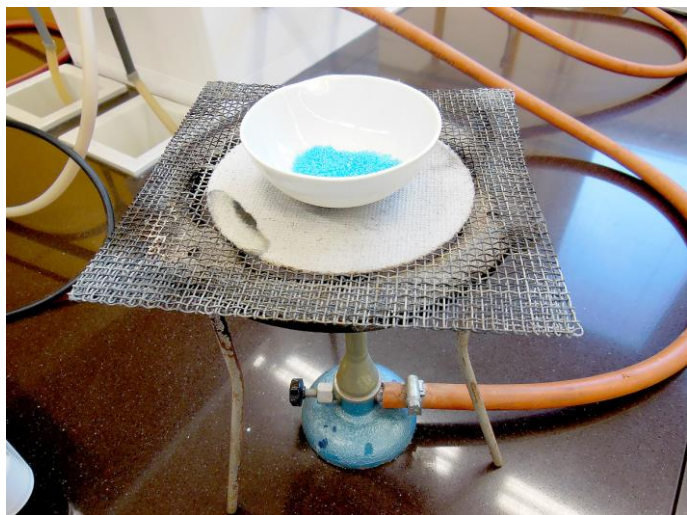
Obrázek 6: Odpařování krystalové vody
