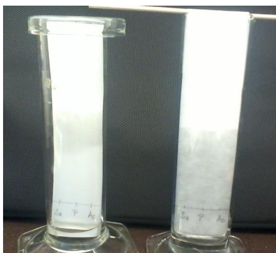
Obrázek 4: Chromatografie na Silufolu (vlevo) a na papíře – produkt uprostřed
