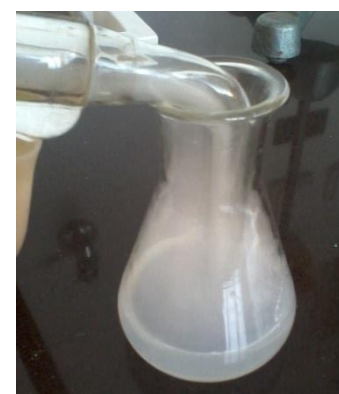
Obrázek 2: Vápenná voda v kuželové baňce se vlivem reakce s oxidem uhličitým postupně zakalí
