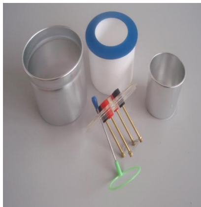
Obr. 2 Elektrický kalorimetr a jeho části
