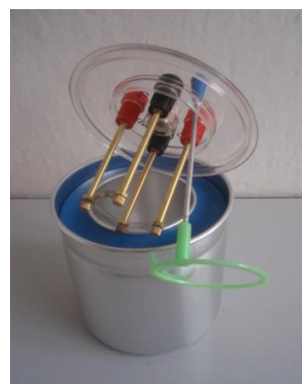
Obr. 3 – Elektrický kalorimetr
