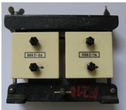
Obrázek 1 Školní rozkladný transformátor na pokusy
