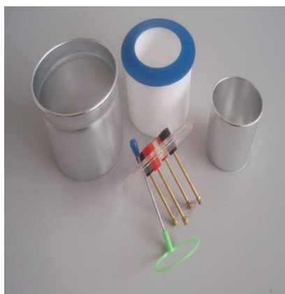
Obr. 2 Elektrický kalorimetr a jeho části
