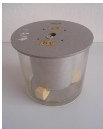
Obr. 1 – Směšovací kalorimetr
